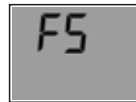
Affichage de l'écran après un simple appui sur une touche. FS = Factory settings (paramètres d'usine)
